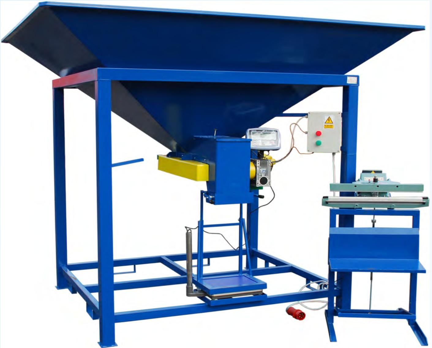
Trattasi di una stazione di insacco semiautomatica ad azionamento elettrico dotata di bilancia di precisione e sistema di chiusura sacchi a caldo.
